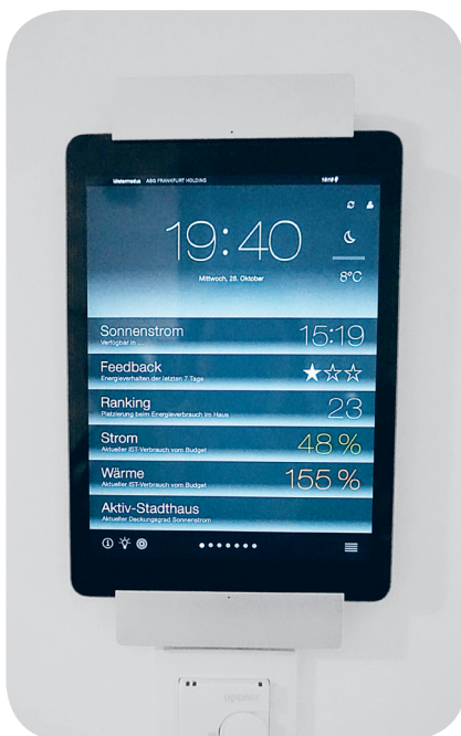
Mit SmartHome die Haussteuerung im Blick: Über mobile Endgeräte kann der Stromverbrauch angezeigt und die Haus-technik gesteuert werden
